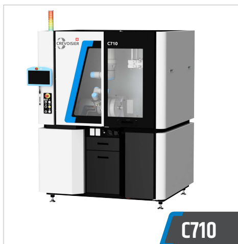
Cellule de polissage collaborative développée par des polisseurs pour des polisseurs
